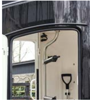
Schutz vor Regen durch die Regenleisten oberhalb der Türen und auch im Heckbereich.
