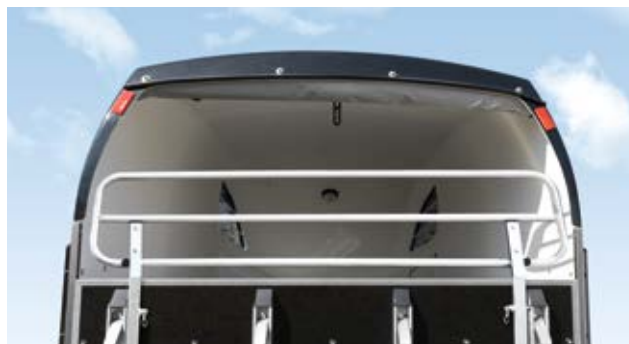
Sicher unterwegs durch ein klappbares Fohlgitter.
